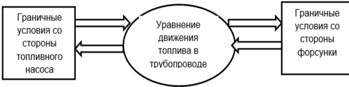
Рисунок 1 – Структурная схема топливной аппаратуры дизеля
